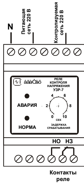
Рис. 1. Схема расположения контактов на клеммнике реле контроля напряжения.
