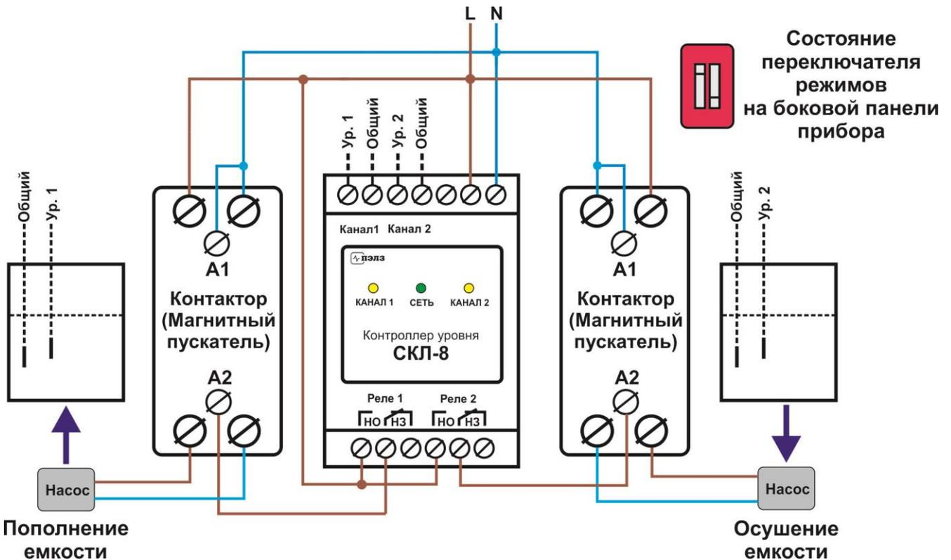
**Схема 2. Управление насосами мощностью менее 300-400Вт напрямую через контакты исполнительных реле СКЛ-8. Канал 1 работает на пополнение емкости, канал 2 на осушение.**
