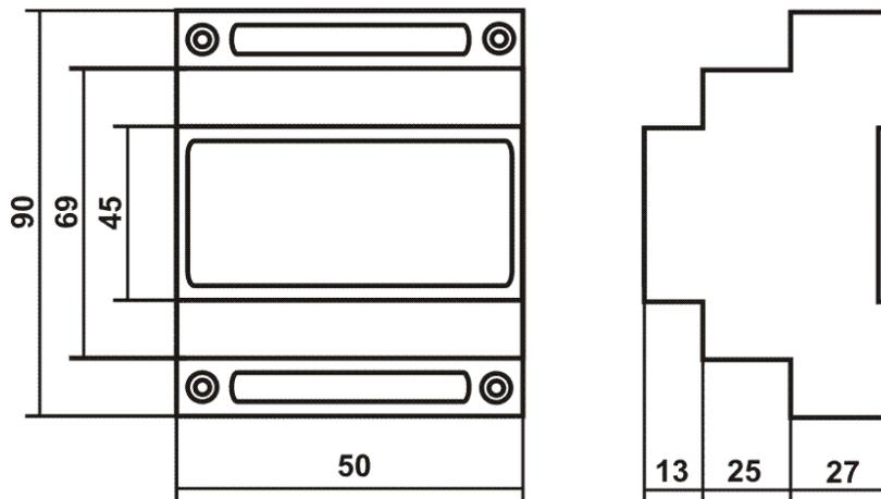
Рис.1. Габаритные размеры корпуса прибора
