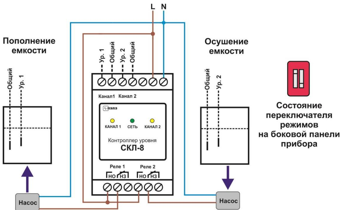
Датчики уровня каждого канала устанавливаются на соответствующих местах в накопительном баке. Общий провод либо присоединяется к корпусу бака (если он металлический), либо устанавливается ниже нижнего датчика.
