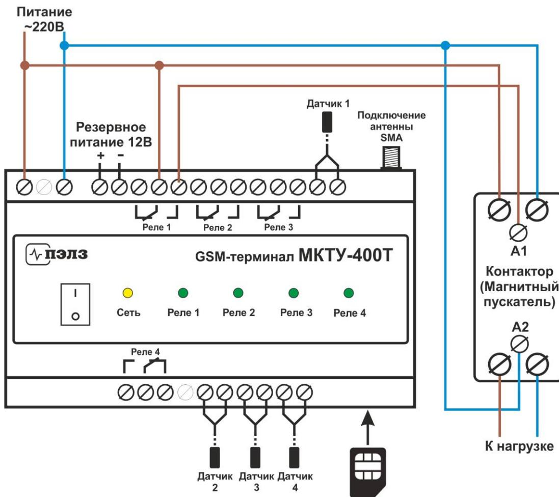
Присоедините к клеммникам провода датчиков, внешних исполнительных устройств, внешнего источника питания 12 В и сети 220 В.
