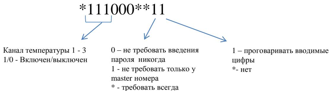
4.3. Ячейка PAROL – предназначена для записи пароля доступа к терминалу «МКТУ-300Т» по телефону, общей настройки терморегулятора, режима отображения СМС-сообщений. По умолчанию в ячейке записано \*1\*1\*1\*1234, т.е. пароль – 1234.
